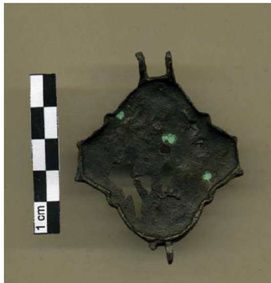
«Бронзовая болезнь» (разновидность рецидивной коррозии медных сплавов)
